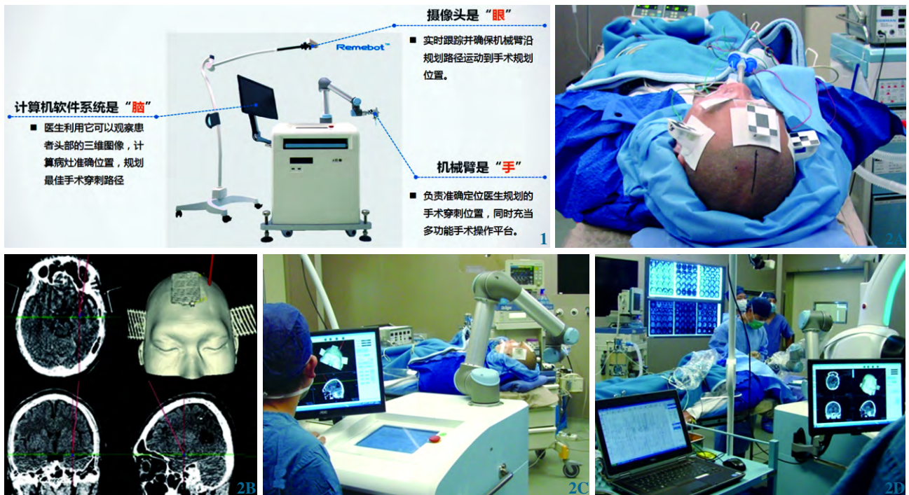
图 1 Remebot 设备外观 图 2 Remebot 手术过程 2A 头部贴标记点,供 CT 或 MRI 扫描 2B 计算机平台规划手术方案 2C Remebot 在视觉识别下进行自动定位 2D Remebot 进行立体定位手术
